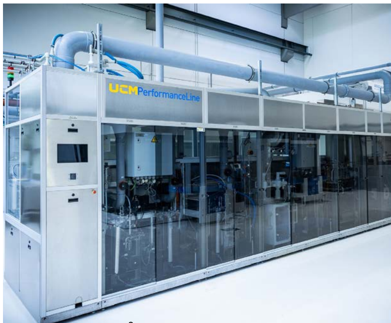
Akár nagy anyagválaszték, magas áteresztőképességi követelmények és/vagy szigorú tisztasági előírásokról van szó, a moduláris felépítésű többfürdős ultrahangos merülőberendezések hatékonyan alkalmazhatók az adott feladathoz – akár tisztatéri integrációra vagy tisztatéri csatlakoztatásra is Kép forrása: Ecoclean
