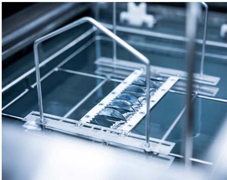
A tisztítandó munkadaraboktól függően a különböző fürdőkben pontosan be kell tartani a meghatározott kezelési időket, ami nagyon magas követelményeket támaszt a folyamatirányításra. Kép forrása: Ecoclean
